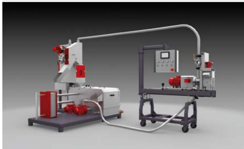
Die Komponenten der ECON-Unterwassergranulierung sind als kompakte Funktionsmodule aus Granuliereinheit und Granulattrocknung zusammengefasst. Bei der Konzeption wurde auf Bedien- und Servicefreundlichkeit besonderer Wert gelegt.
